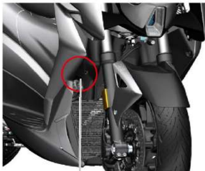
Cubierta principal al vaso de expansión
